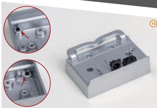
16 В верхней части половины блока установите выпускной коллектор. Закрепите деталь с внутренней стороны блока двумя винтами 1,7×4 (АМ). Обратите внимание: правильно установленная деталь выходит за габариты блока двигателя.
