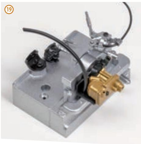
19 Протолкните имитацию тяги ручного управления акселератором (виниловую трубку меньшего диаметра) в отверстие кронштейна оболочки тяги и закрепите ее конец в отверстии рычага тяги ручного управления акселератором (внутри квадратного прилива).
