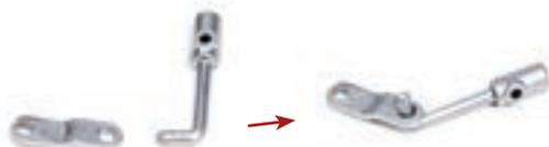
Вставьте изогнутый стержень тяги дроссельной заслонки в одно из отверстий рычага тяги дроссельной заслонки. Конiec стержня имеет утолщение, за счет этого он держится в отверстии.
