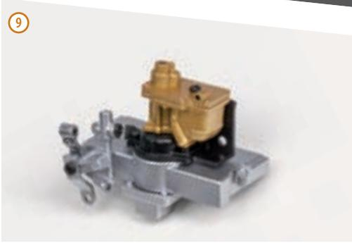
9 Подтяните тягу дроссельной заслонки к установленному на карбюратор рычагу дроссельной заслонки и скрепите детали при помощи винта 1,7×3 (CP).
