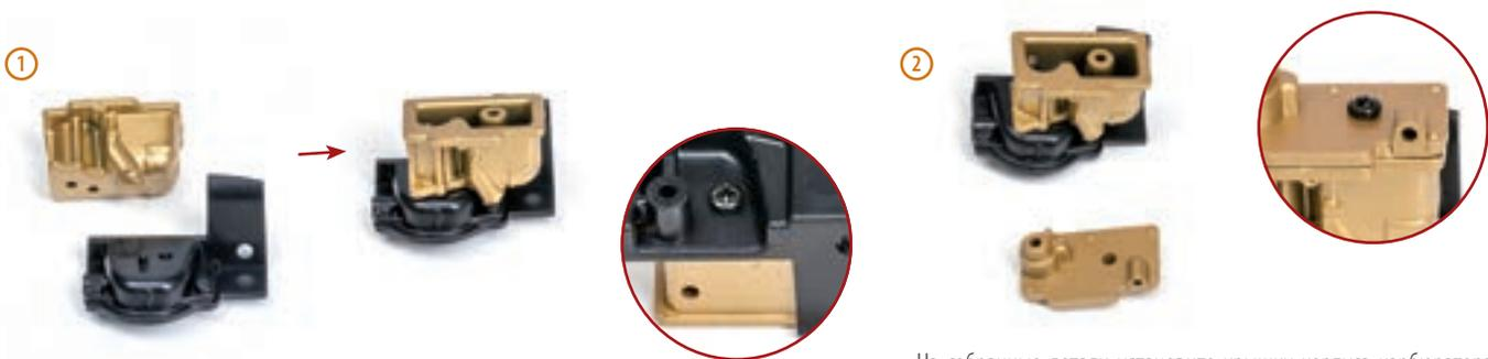
Поместите корпус поплавковой камеры поверх корпуса смесительной камеры карбюратора. Совместите центровочные элементы и закрепите детали винтом 1,7×5 (BP) с нижней стороны корпуса смесительной камеры.
