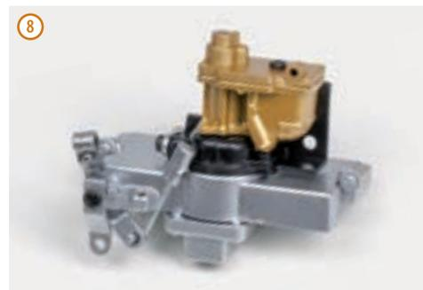
Соединенные вместе детали закрепите на боковом крепежном приливе впускной трубы. При этом кронштейн оболочки тяги ручного управления акселератором должен находиться в верхней части.
