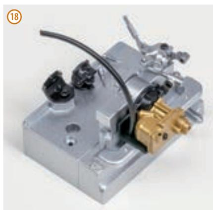
18 Установите шланг вентиляции в отверстие на корпусе смесительной камеры карбюратора. На данном этапе сборки не рекомендуется пользоваться клеем для окончательной фиксации шлангов.
