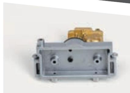
Собранный карбюратор установите на впускную трубу и закрепите его винтом 1,7×5 (BP) с нижней стороны трубы.
