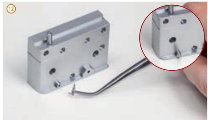
12 Установите штуцер масляного шланга на приливе боковой поверхности блока (ближе к задней части). Свободный конец штуцера должен ориентироваться вверх и немного назад.
