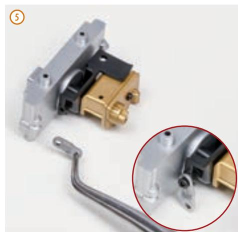
На заднем торце корпуса смесительной камеры карбюратора установите и закрепите винтом 1,7×5 (BP) рычаг дроссельной заслонки. Обратите внимание: рычаг в центре имеет изгиб. Фиксировать винтом необходимо более длинную относительно изгиба часть рычага.
